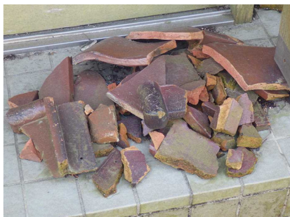
写真4-7-6 須賀川市内の破損した赤瓦 ※陶土、施釉が石州瓦と異なり、越前系に近い。 会津の瓦と似ているが陶土が異なる(写真4-7-2)。 (阿部撮影 2015年)
