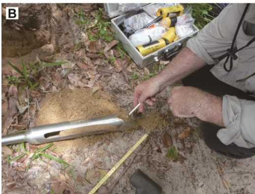
図 2. 現地調査の風景. A) 地中レーダと地形測量. B) ハンドオーガーからの粒度分析試料の採取. C) 掘削したピットからの粒度分析試料 (5 cm 刻み) の採取と、ルミネッセンス年代測定試料 (黒チューブ) の採取.
