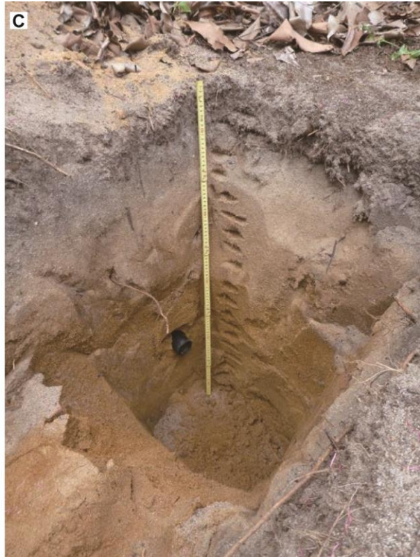
図 2. 現地調査の風景. A) 地中レーダと地形測量. B) ハンドオーガーからの粒度分析試料の採取. C) 掘削したピットからの粒度分析試料 (5 cm 刻み) の採取と、ルミネッセンス年代測定試料 (黒チューブ) の採取.
