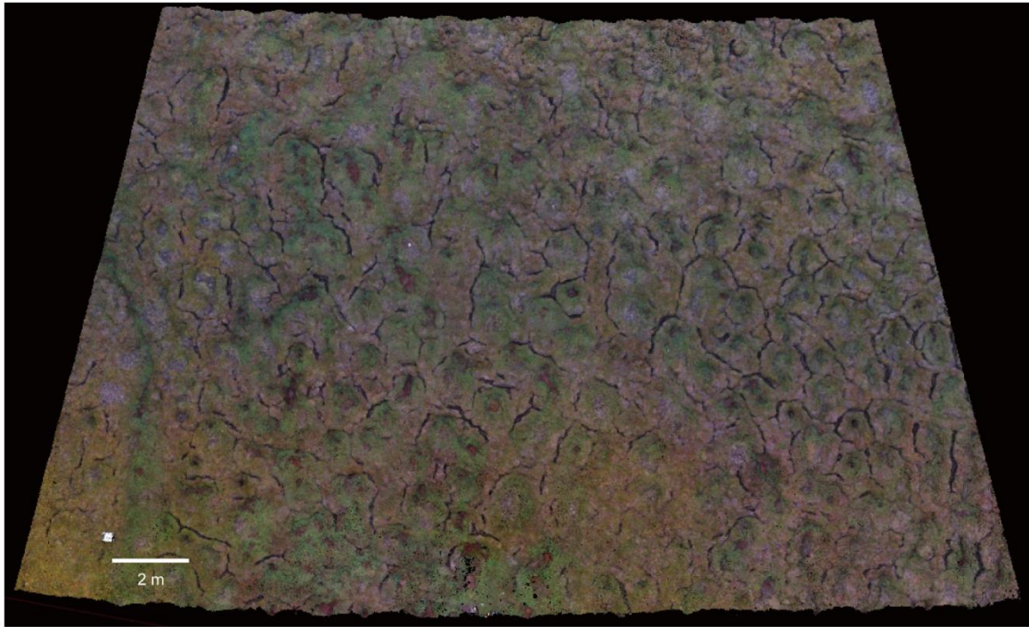
図 4. 複合型構造土の立体モデル. UAV (Unmanned aerial vehicle)と SfM (Structure from motion)により作成.
