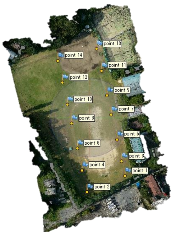
図 10 自律飛行テスト用対空標識の配置
