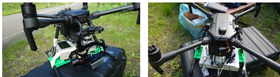
図 3.3.2.1 地中構造解析システムを搭載した状態
