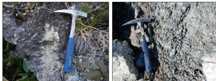
図 2.2.2 地すべり末端に露出する蛇紋岩
