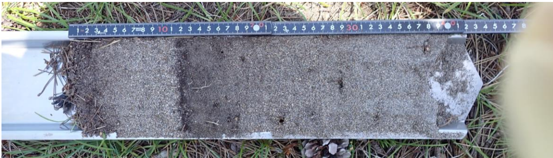
図8 掘削調査結果. 左側が上位（地表面側）. 表層から 3cm~12cm 付近に津波堆積物と考えられる白砂層が認識できる.
