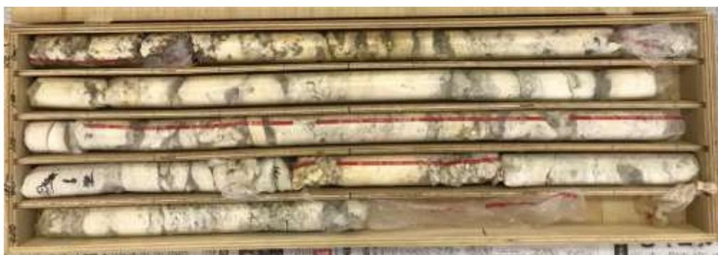
図3 I面 A 地点から回収された掘削コア写真。コア箱の長辺が約 1m
