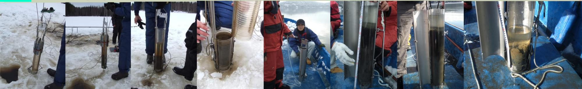
リミノスグラビティーコアサンプラー (LIMNOS gravity core sampler; by LIMNOS Ltd. <http://www.limnos.fi>) を用いて、表層堆積物サンプリングを行う。湖底表層の約1m上から自由落下させることで堆積物の採取をおこなう。サンプラーの引き上げ時に、ストッパーを外れ、底のフタがしまることで、未攪乱堆積物が採取できる。旧式・新式サンプラーとも直径8cm、最大深度55cmの円柱状の表層堆積物の採取が可能である。ウェイトを付けることで、押し込む深度調整は可能である。作業は、結氷湖上（左の4枚の写真）、ボート上（右の4枚の写真）でもどちらでも可能。
