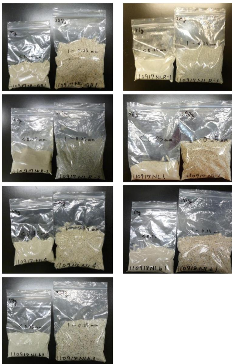
図6 粉碎，整粒後の試料. 1~0.25 mm粒径の試料を分析に用いる.
