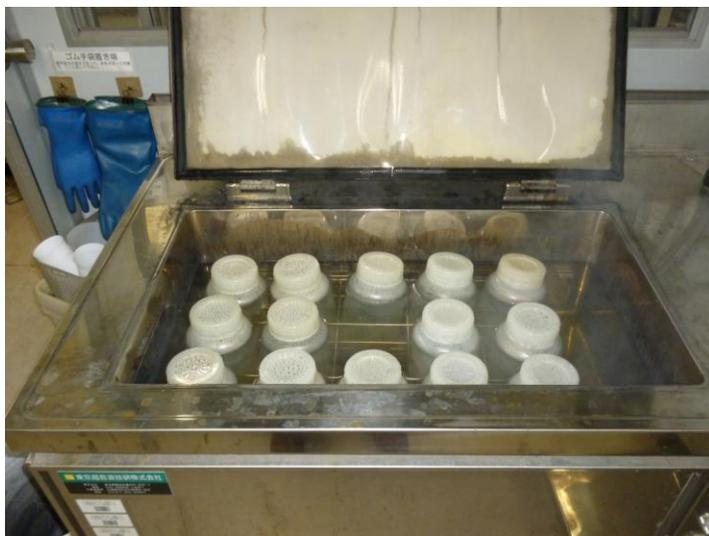
図8 大型超音波水槽でフッ酸リーチング中の試料.
