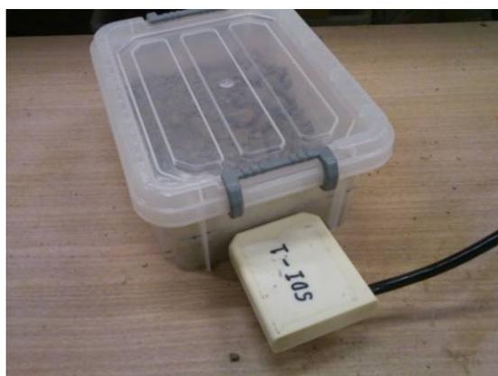
図 2-14 2 極センサーキャリブレーション
