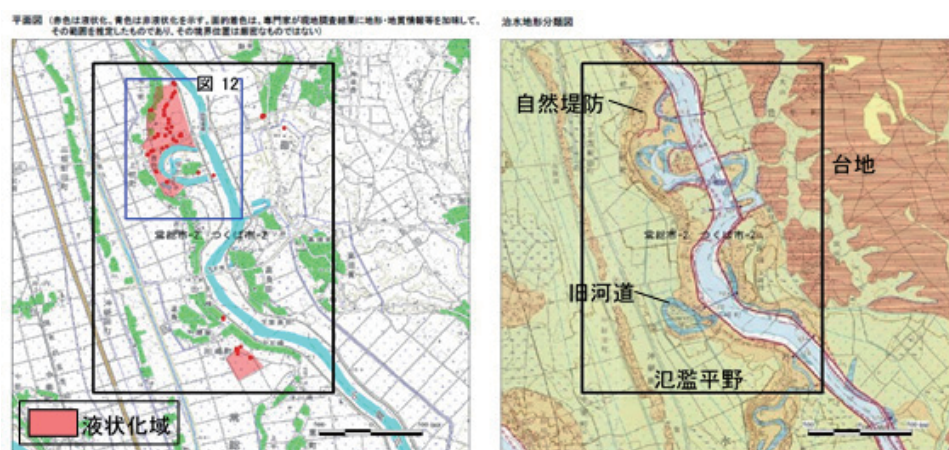
図 11 常総市東部（上蛇町、川崎町）における液状化発生域と地形区分 国土交通省関東地方整備局・公益社団法人地盤工学（2011）に加筆
