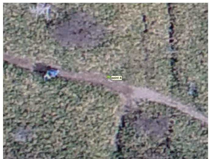
図 3-3 GCP の例 (point 4 は地中に埋った塩ビパイプが一部で地面から露出していた場所を選んだ)
